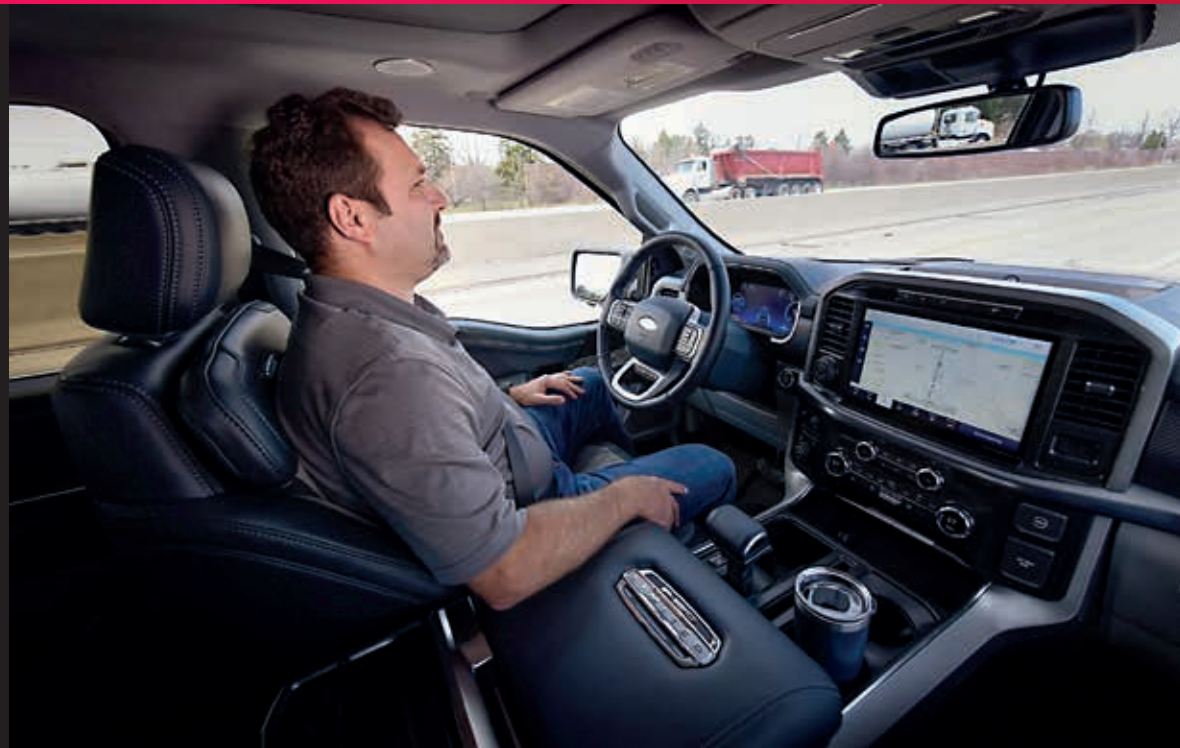
▲ Fordin BlueCruise-järjestelmä edustaa L2+-tason järjestelmien hienostuneempaa joukkoa. Järjestelmä kykenee toimimaan laajoissa toimintaolosuhteissa ja moottoritienopeuksissa ilman, että kuljettajan kädet ovat ohjauspyörällä. Kuva: Ford
