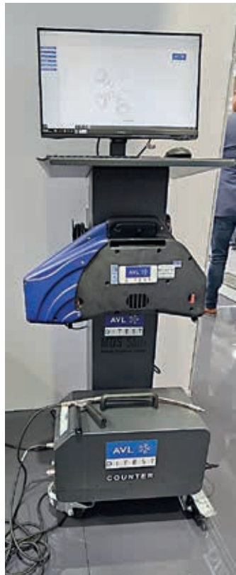
▲ AVL DiTEST päästöjen mittaustilaite, joka on laajalti Suomessa käytössä varustettuna "Counter" partikkelimittarilla. Ympäri maailman muuttuva päästölainsäädäntö edellyttää uutta mittauseriaa hiukkasten määrän mittaamiseksi. Mittausperiaate on hiukkasten sähkövarauksia laskeva. Käytetty tekniikka on jo hyväksytty Saksassa, Sveitsissä ja Hollannissa. Diagno Finland Oy on tuonut ensimmäiset mittalaitteet koekäyttöön Suomeen ja testitulokset ovat vakuuttavia.
